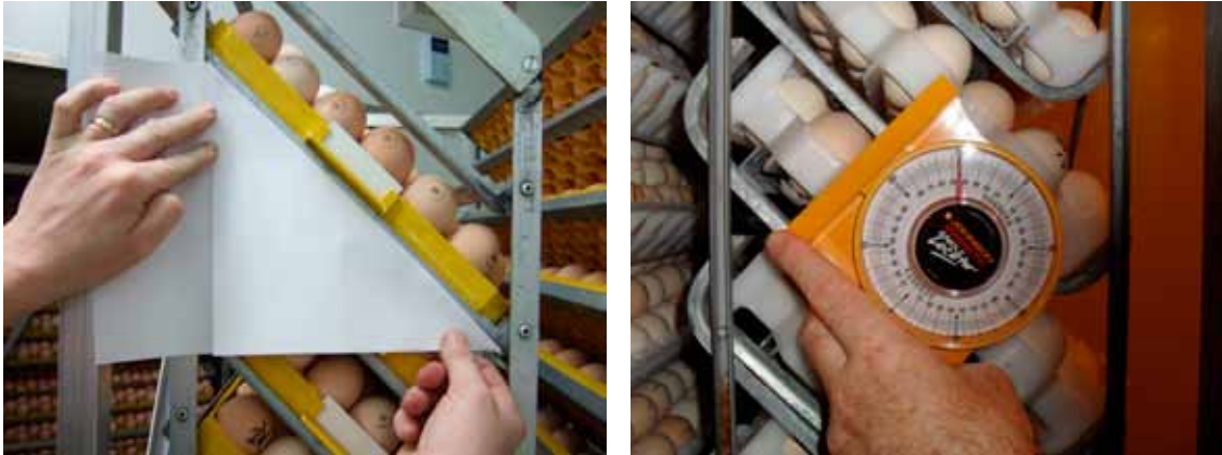
Схема 4: Проверка угла поворота яиц.
