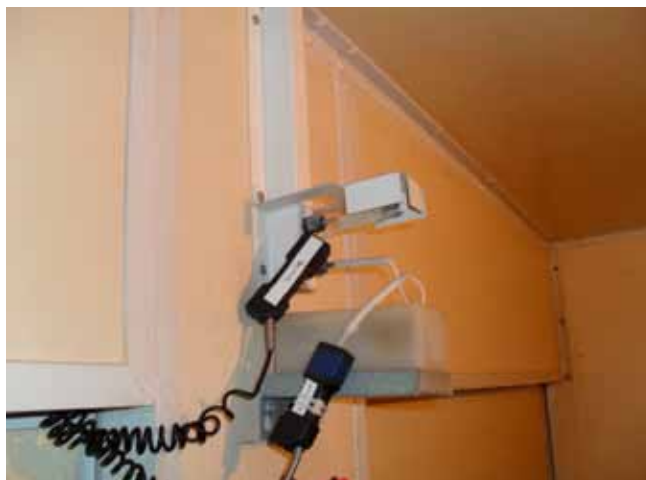
Схема 7: Калибровка с помощью чтения калибровочного датчика, установленного рядом с температурным сенсором шкафа.
