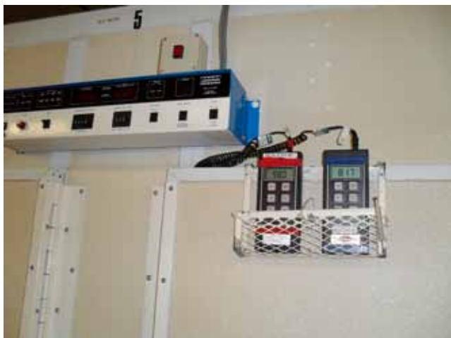
Схема 7: Калибровка с помощью чтения калибровочного датчика, установленного рядом с температурным сенсором шкафа.
