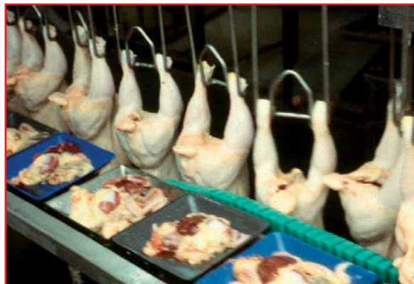
13. ábra: Egy epével szennyezett vágott test, amely tisztítást és további kezelést igényel.
