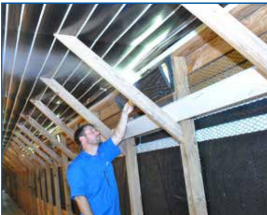
图 6.7:使用烟雾测试来确定气流和工作压力是否正确。
